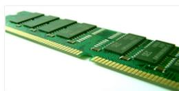
La RAM est un type de mémoire qui équipe tout ordinateur et qui permet de stocker des informations provisoires et de les restituer avec une vitesse bien supérieure à un disque dur. Si le processeur calcule, la mémoire stock les calculs en cours. Les deux font la puissance de l'ordinateur.
