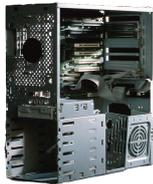
C'est la carcasse de votre ordinateur, dans laquelle on vient ranger les différents éléments ! Elle doit permettre une bonne ventilation pour éviter les surchauffes. Penser à bien la nettoyer et éviter les accumulations de poussières.
